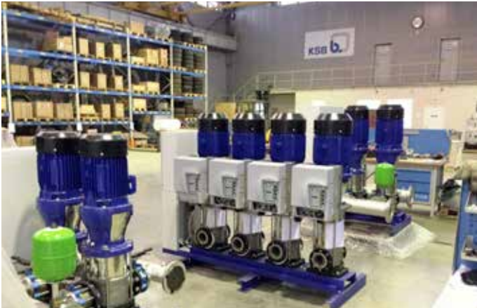
Установки повышения давления для систем водоснабжения/ пожаротушения зданий и сооружений
